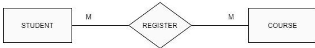
ภาพที่ 2.3 แสดงความสัมพันธ์แบบ Many To Many
